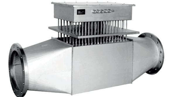
Ausführung für hohe Temperaturen mit abgesetztem Anschlusskasten, Kühlstrecke und Anschluss für Wärmedämmung.
